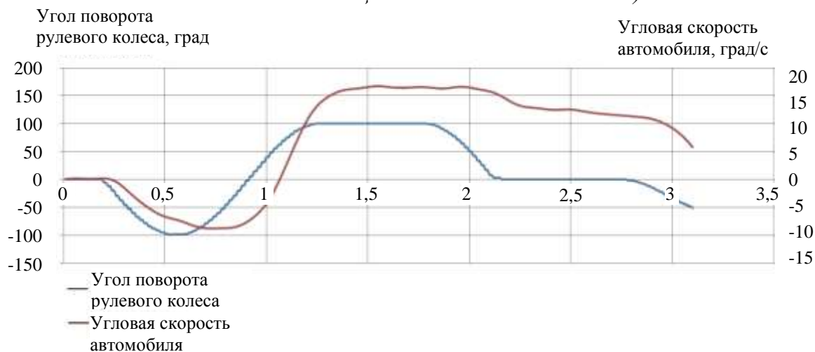
Рис. 8. Зависимости угла поворота рулевого колеса и угловой скорости автомобиля (скорости «рыскания») (при нефункционирующей ЭКУ, автомобиль оснащён шипованными шинами)
