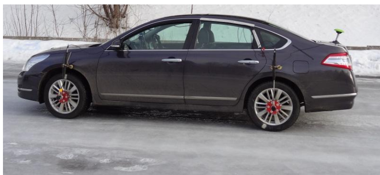
Рис. 4. Измерительный комплекс для оценки эффективности действия системы ЭКУ
