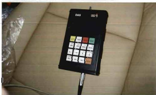
Рисунок 7. Система сбора и обработки данных DAS-3: а) основной модуль; б) блок управления и отображения
