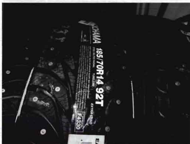
Рисунок 11. Зимняя шина Yokohama iceGUARD Stud IG35: а) прошедшая ошиповку; б) не прошедшая ошиповку
