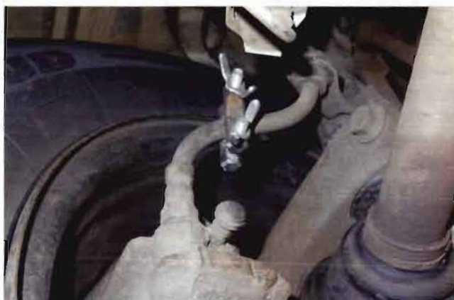
Рисунок 9. Струбцина для пережатия тормозных шлангов (а) и её установка (б)
