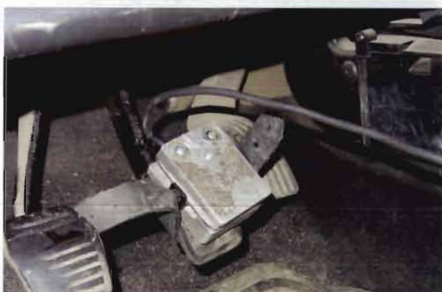
Рисунок 6. Датчик усилия нажатия на педаль тормоза (а) с блоком питания и индикации (б)
